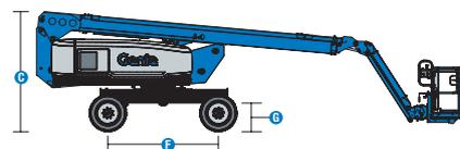
(1) En el sistema métrico, altura de trabajo = altura de la plataforma + 2 m.
